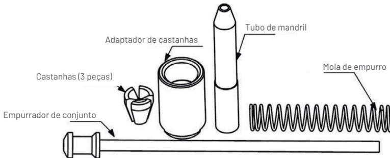
6. Monte novamente as peças limpas ou peças novas, conforme abaixo. Colocar a mola de empurro (#6) no empurrador do conjunto (#5) e inserir de volta na ferramenta onde o cilindro de óleo do conjunto (#13) está alocado.
