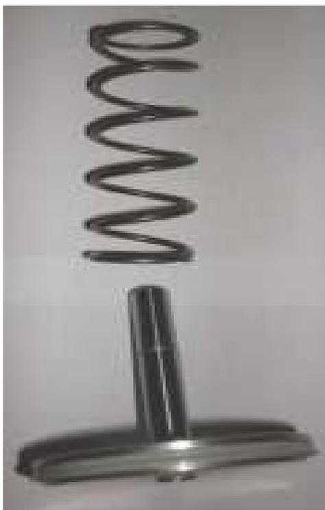
**4º:** Remova a montagem do Pistão Pneumático;
